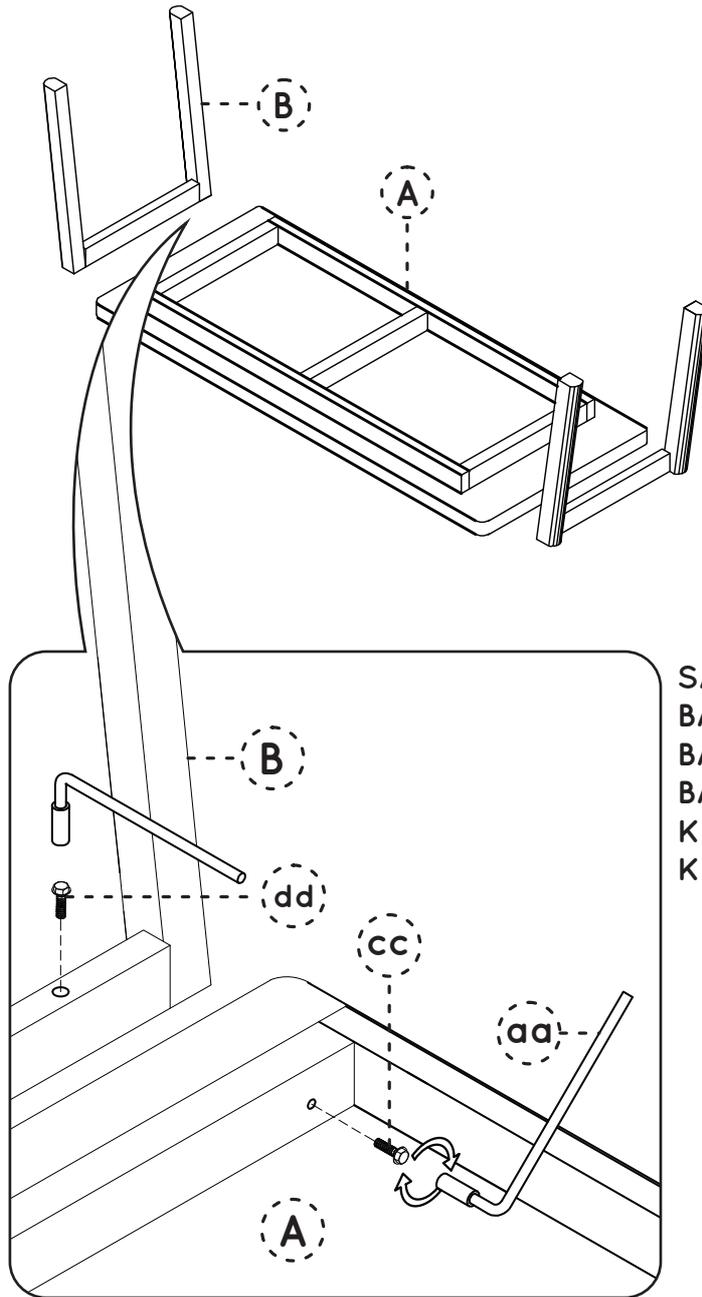
SAMBUNGAN SISI RANGKA BANGKU DENGAN KAKI BANGKU MENGGUNAKAN BAUT PANJANG (CC). KENCANGKAN DENGAN KUNCI SHOCK (AA).
